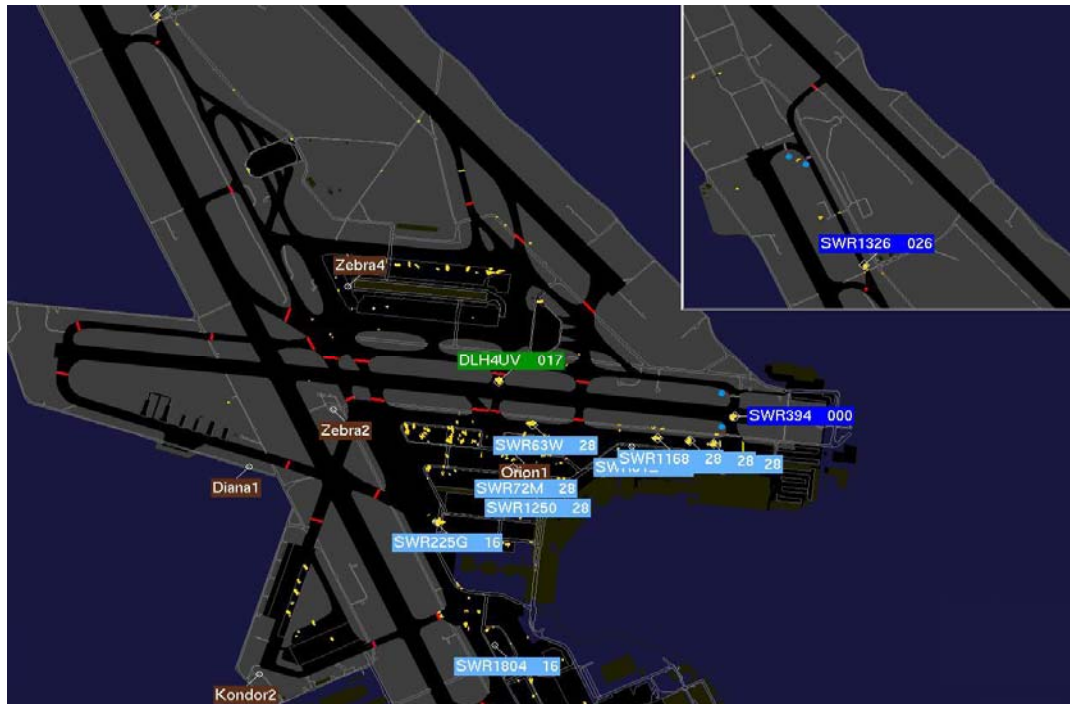
Abbildung 11: Bildschirm des Bodenradars SAMAX. Der nördliche Teil des Pistenystems wird in einem separaten Ausschnitt ( inset ) des Bildschirms dargestellt.
