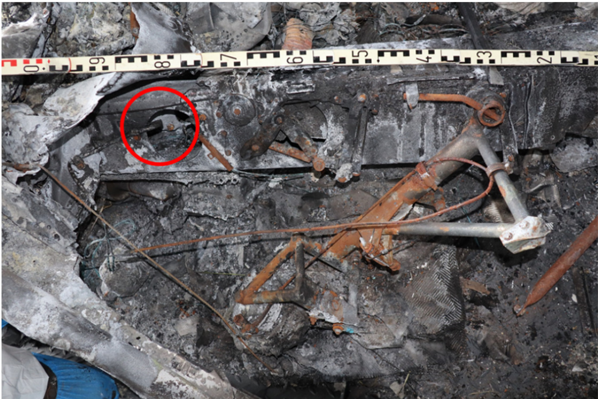
Abb. 8: Abgescherte Treibstoffleitung (roter Kreis) im rechten Fahrwerksschacht
