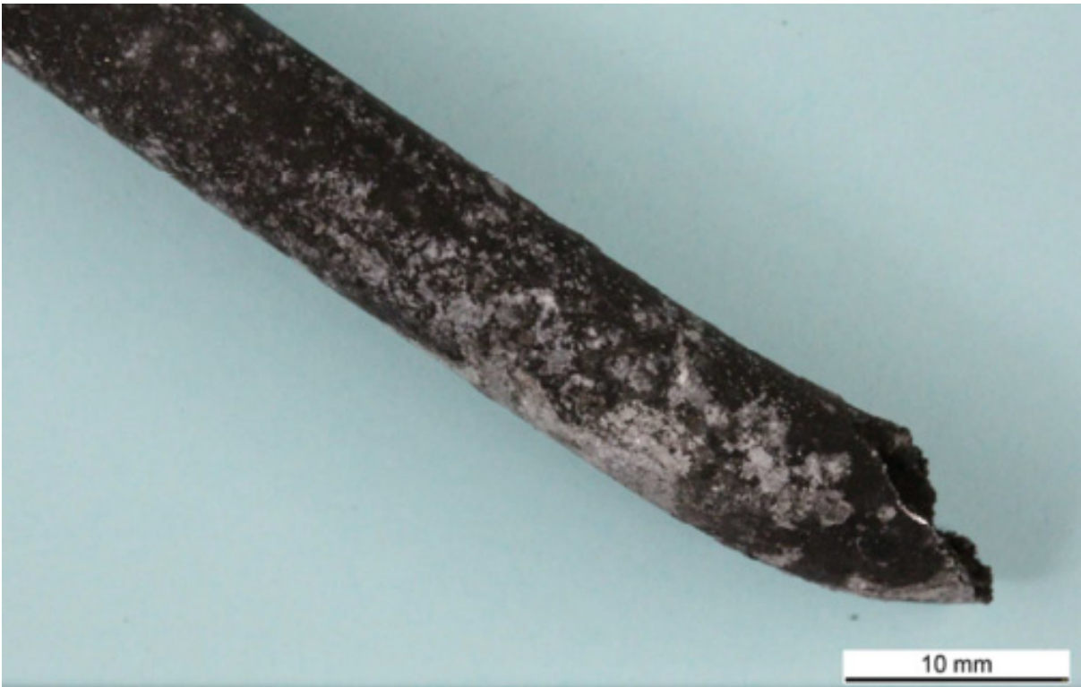
Abb. 9: Übersicht Bruchbereich, stark korrodiert, keine Einschnürung
