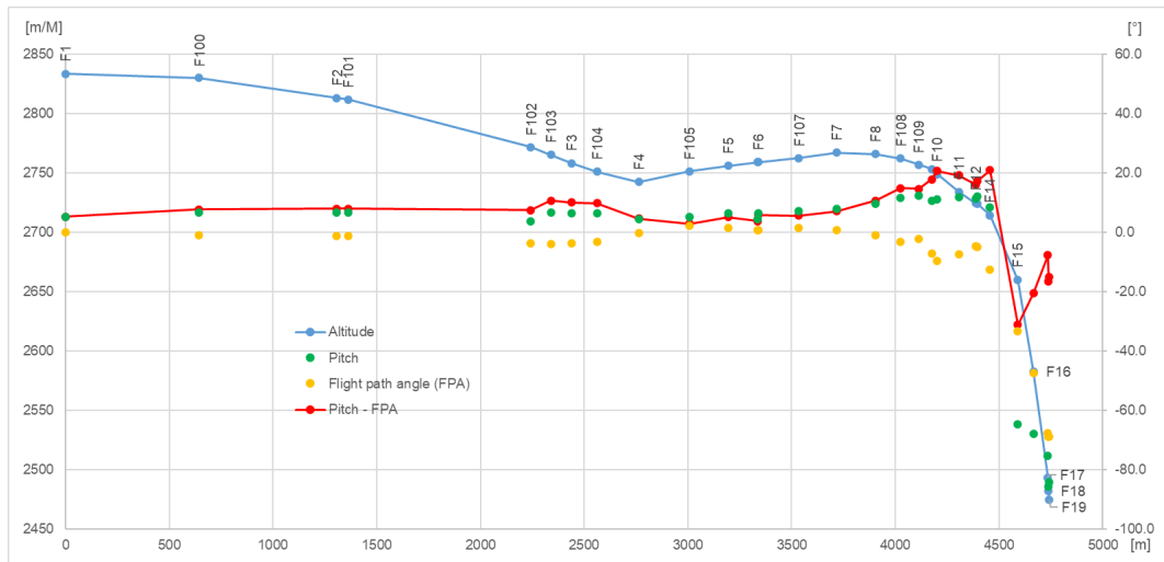
Abbildung 15: Flughöhe ( altitude ), Längslagewinkel ( pitch ) und Flugbahnwinkel ( flight path angle – FPA) in Funktion des horizontalen, zurückgelegten Weges. Auf der linken Ordinate ist der Wert der Flughöhe, auf der rechten Ordinate sind die Werte der Winkelgrößen angegeben.
