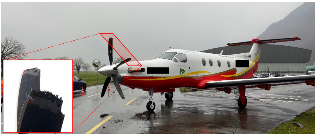
Abbildung 3: Endposition der HB-FRP kurz nach der Kollision mit dem Auto, Blickrichtung entlang der Kantonsstrasse gegen Westen. Der (rote) Ausschnitt zeigt die Beschädigungen an den oberen Propellerblattspitzen.
