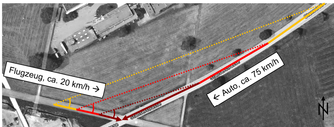
Abbildung 9: Aufsicht mit den Positionen des Flugzeuges auf dem Rollweg (links) und den Positionen des Autos auf der Kantonsstrasse (rechts) während der letzten 10 Sekunden vor der Kollision. Relativ zur Längsausrichtung des Flugzeuges erschien das Auto immer unter dem gleichen Winkel auf der linken Seite (stehende Peilung).
