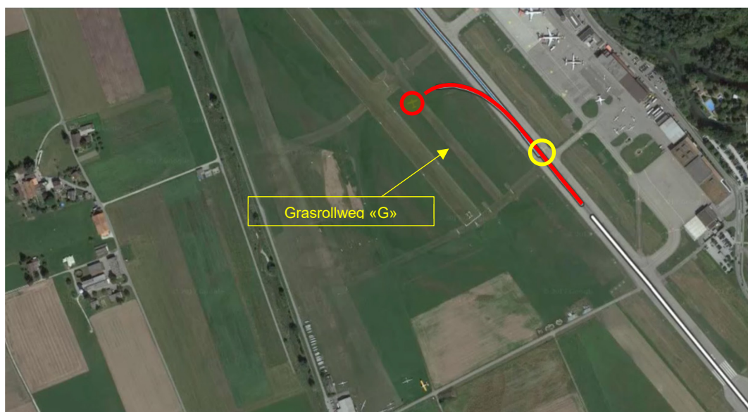
Abbildung 1: Darstellung der anhand der Auswertung der Daten des GPS-Navigationssystems rekonstruierten Flugbahn der HB-SRC. Die blaue Linie illustriert die Startphase, die weisse Linie die Anflugphase und die rote Linie die Landungsphase ab Beginn des Endanflugs bis zur Endlage des Flugzeugs, die durch den roten Kreis dargestellt ist. Der gelbe Kreis bezeichnet den Aufsetzpunkt für einmotorige Flugzeuge.
