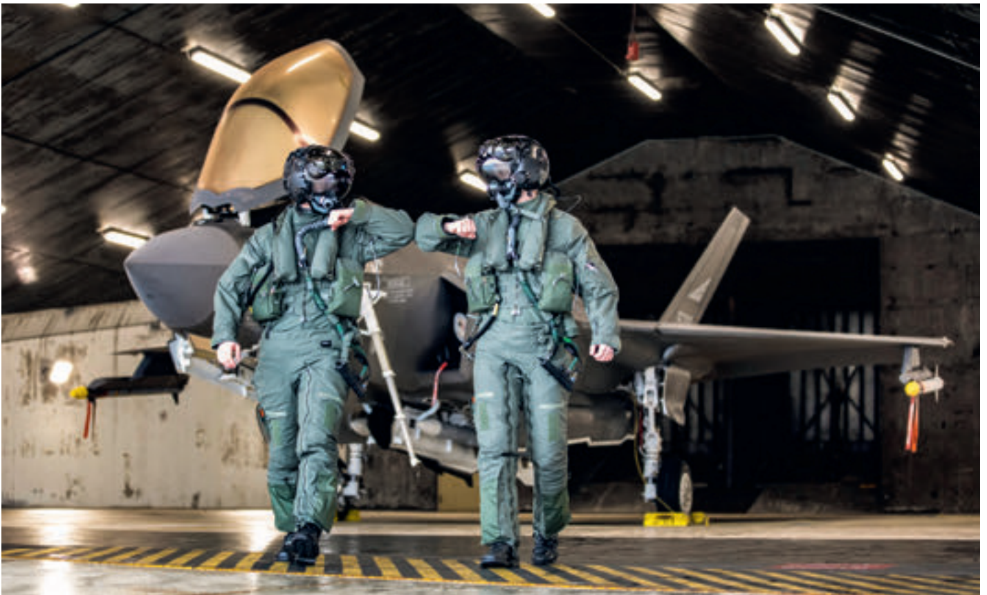
Der Helm von F-35-Piloten ist integrierter Systembestandteil. Informationsdarstellung im Visier und Nachtsichtfunktion gehören zu den Funktionalitäten. – Le casque des pilotes du F-35 est un élément intégré du système. L'affichage des informations dans la visière et une fonction de vue nocturne sont des fonctionnalités additionnelles.
