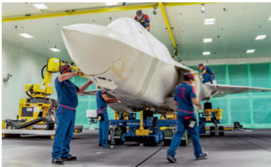
Die radarabsorbierenden Materialien des F-35 verlangen in der Produktion besonderes Know-how. – Les matériaux absorbant les ondes radar du F-35 exigent des connaissances spéciales lors de la production.
