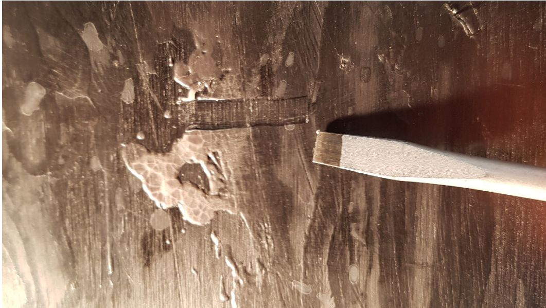
Abbildung 8: Belag eines Skis mit Laufrichtung nach oben, mit der Klinge eines Schraubenziehers zum Grössenvergleich. Gut erkennbar ist die ungleichmässig und in flüssiger Form aufgetragene Wachsschicht mit einer vom Schraubenzieher eingebrachten Furche.
