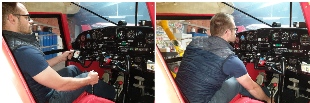
Abbildung 7: Ein Pilot beim Ergreifen des Handhebels zur Verstellung der Landeklappen, links mit den Landeklappen in Landstellung 48^\circ , rechts in Reiseflugstellung -7^\circ .
