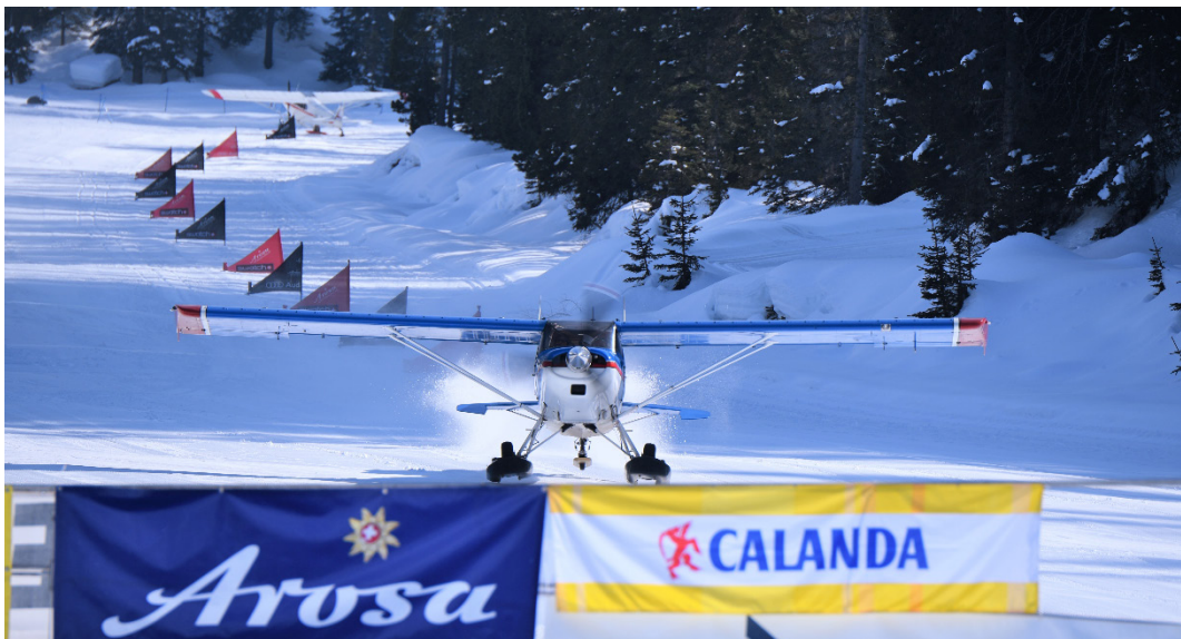
Abbildung 4: Die Maule N561LC während ihres Startlaufs nach erfolgter Richtungsänderung. Erkennbar sind die Unterseiten der Ski und eine durch das Aufschlagen des Heckfahrwerks auf der Schneefläche hervorgerufene Schneefahne hinter dem Flugzeug.
