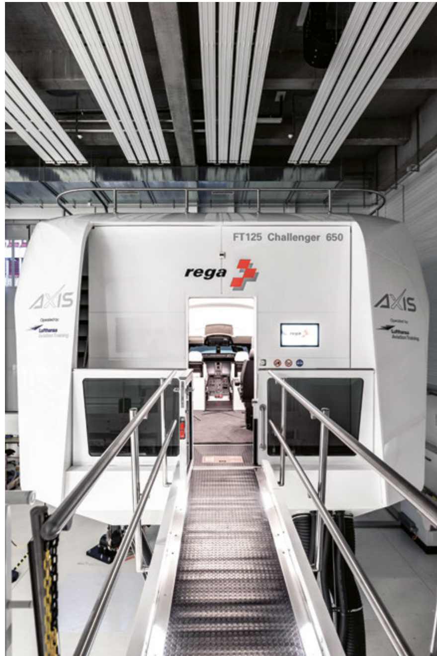
Die beiden für die Rega entwickelten Simulatoren – im Bild der Jetsimulator – stehen für das Training von Standardsituationen und Notverfahren, die in echt nicht oder kaum geübt werden können, bereit.
