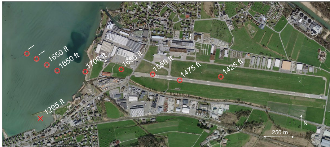
Abbildung 1: Radaraufzeichnungen (rote Punkte) und Unfallstelle (rotes Kreuz) mit Angaben der Flughöhen über Meer resp. «---», wo keine Höhen aufgezeichnet wurden. Die erste Aufzeichnung erfolgte um 14:35:22 Uhr, die weiteren in einem Abstand von jeweils 5.2 s. Die dargestellten Positionen sind mit Ungenauigkeiten behaftet, da sie einzig von der Radarstation Gosheim (D) aufgezeichnet wurden, die sich 50 NM nordwestlich des Flugplatzes befindet. Der Flugplatz liegt auf 1306 ft über Meer. Quelle der Basiskarte: Bundesamt für Landestopografie.
