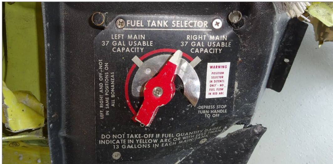
Abbildung 2: Tankwählschalter ( fuel selector ) der HB-EJE wie vorgefunden.
