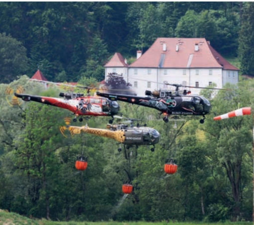
Mit einer Aussenlastkapazität von maximal 750 Kilogramm war die Kapazität im Löscheinsatz zwar begrenzt, doch die Alouette wurde auch bei der Brandbekämpfung mit Bambi Buckets intensiv genutzt.
