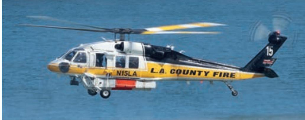
Bei diesem S-70A des LA County Fire Department handelt es sich um einen Firehawk der ersten Generation. Zu sehen ist er hier bei einer Übung zum Absetzen und Aufnehmen von Rettungsschwimmern über dem Castaic Lake nördlich von Los Angeles.
