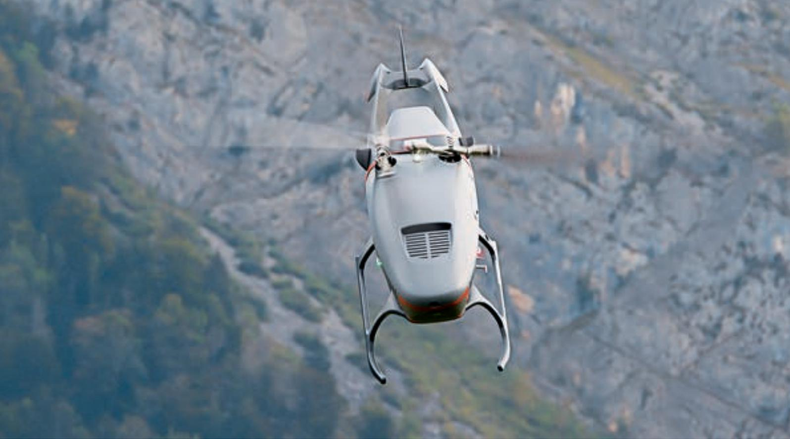
**Der Kleinheli wird von einer Wellenturbine mit 15 kW Leistung angetrieben und gilt als sehr vibrationsarm.**
