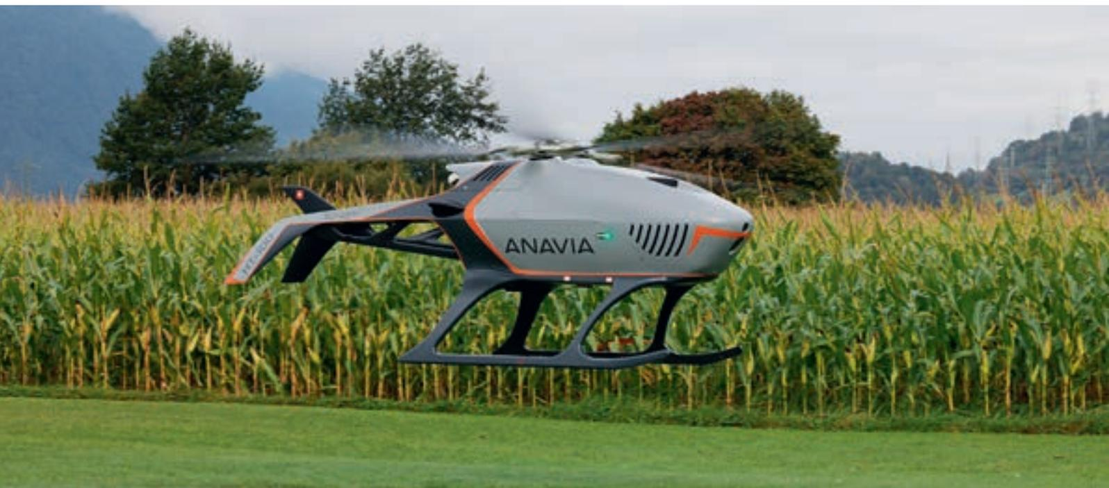
Beim Flettner-Doppelrotorsystem mit zwei gegenläufigen Hauptrotoren entfällt der sonst übliche Heckrotor. Damit steht mehr Kraft für die Auftriebserzeugung zur Verfügung und der HT-100 ist deutlich leiser als vergleichbare Helikopter.
