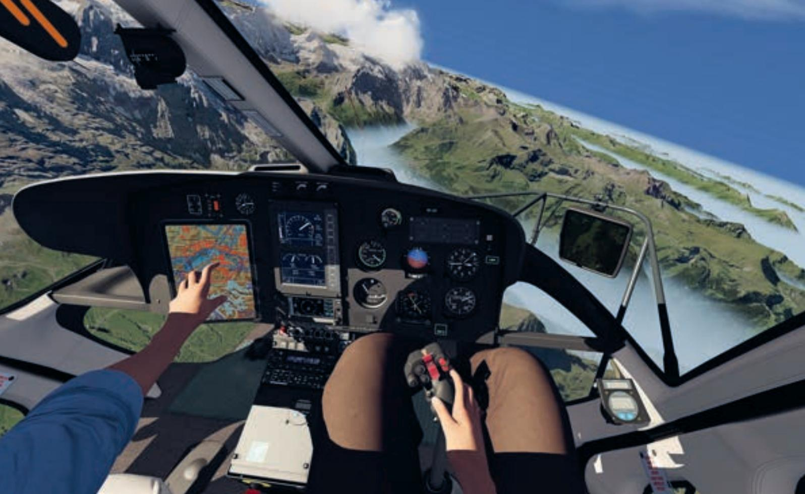
H125 Flight Simulation Training Devices (FSTD) von Loft Dynamics – der Simulator mit EASA- und FAA-Qualifikation ermöglicht neue Ausbildungs- und Trainingskonzepte.
