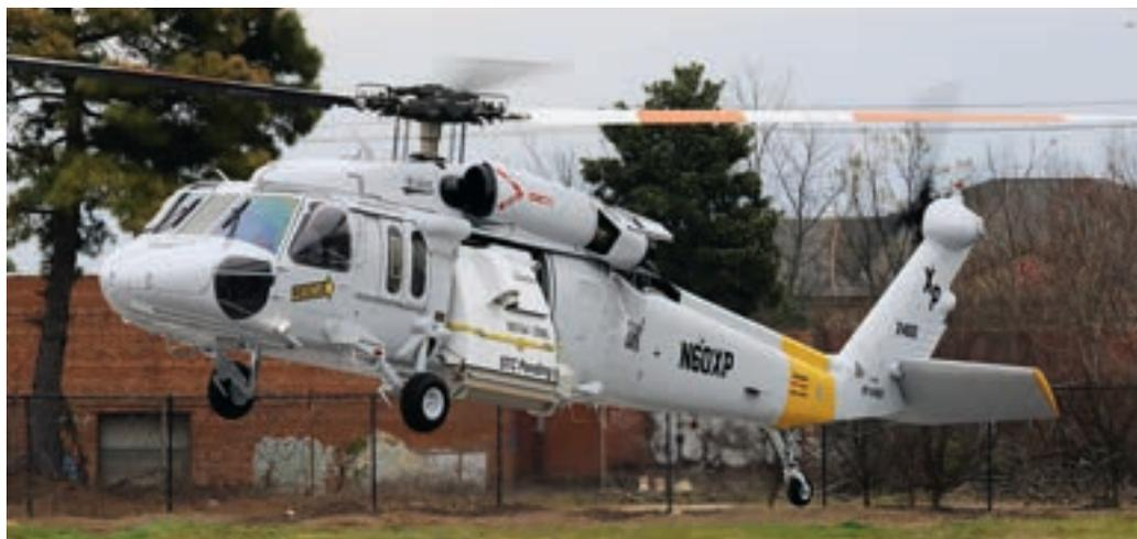
Der Transport von Löschwasser in einem in der Kabine montierten Tank ist eine weitere Innovation. Zwei Firmen bieten solche Tanks mit einem Fassungsvermögen von zwischen 850 und 1000 US-Gallonen an, darunter dieser von BHI H60 für 925 US-Gallonen.
