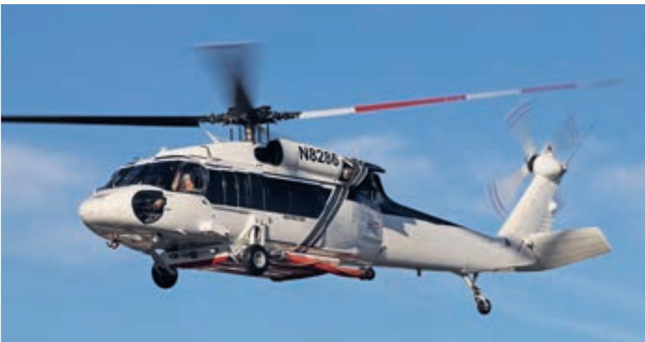
Dieser UH-60A von HP Helicopters wurde für die Zertifizierung des FT4500 Wassertanks der australischen Firma HeliTak verwendet. Dieser ist unter dem Rumpf angebracht, fasst 4500 Liter und dehnt sich nach unten aus. Nach dem Wasserabwurf zieht er sich wieder in seine Ausgangshöhe von nur 30 Zentimeter zurück, weshalb das Originalfahrwerk belassen werden kann.
