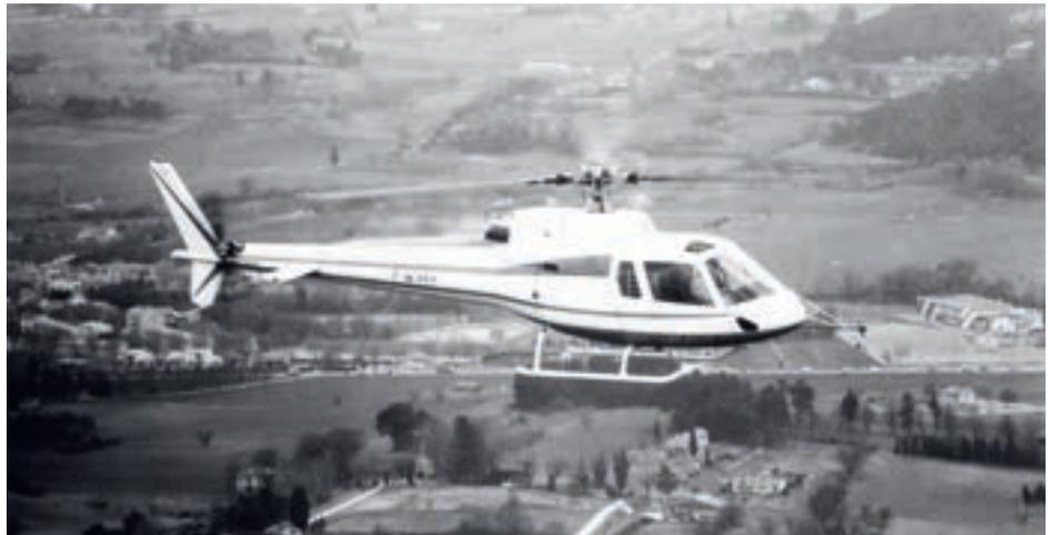
Das Ecureuil mit der Seriennummer 001: Aérospatiale AS350 F-WVKH im Jahr 1974 auf einem Testflug, ausgerüstet mit der US-amerikanischen Lycoming LTS101-600A Turbine. Foto Airbus Helicopters
