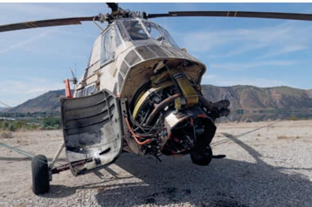
Einfach ist die Wartung des 1525 PS starken Neunzylinder-Wright R-1820-84D Cyclone Kolbenmotors dank den geöffneten Bugklappen.
