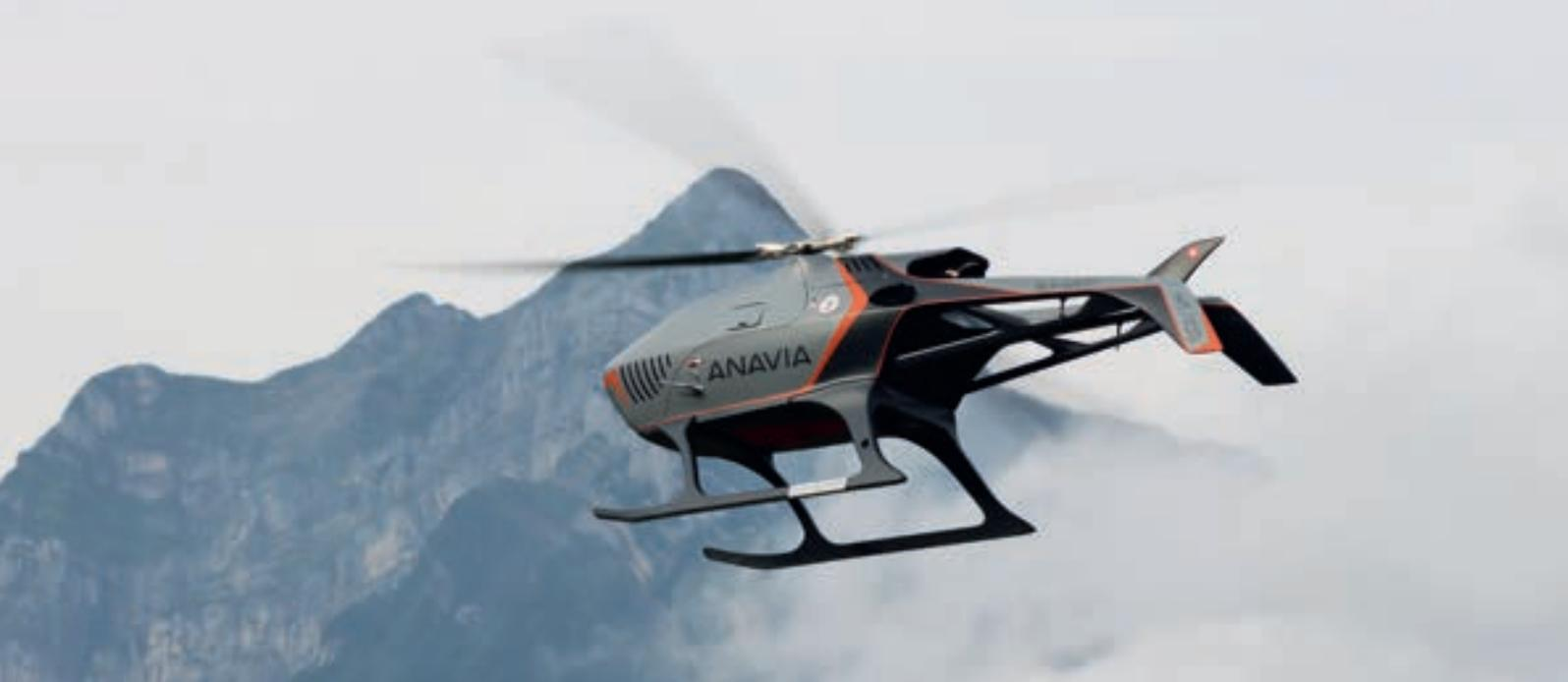
**Der Kleinheli von ANAVIA ist in erster Linie das Transportmittel für Kameras oder Sensoren, die Daten sammeln. 40 Prozent der Einsätze dieser Helis gehen aufs Konto von solchen Aufklärungsflügen.**
