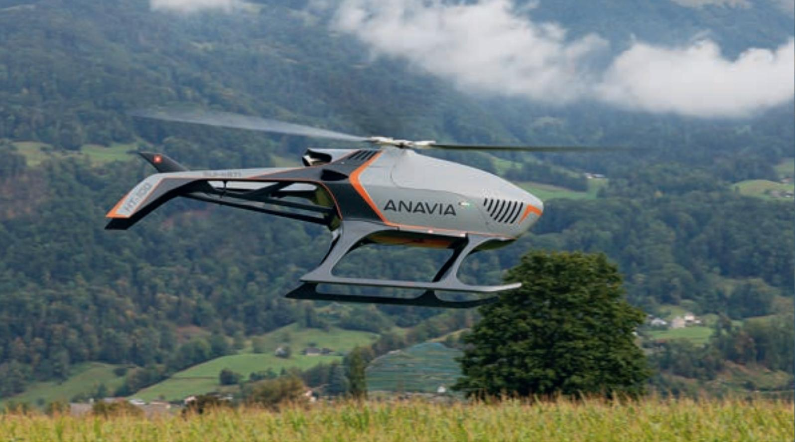
Mit seinem maximalen Startgewicht von rund 120 Kilogramm kann der unbemannte Hochleistungskleinhelikopter bis zu sechs Stunden in der Luft bleiben.
