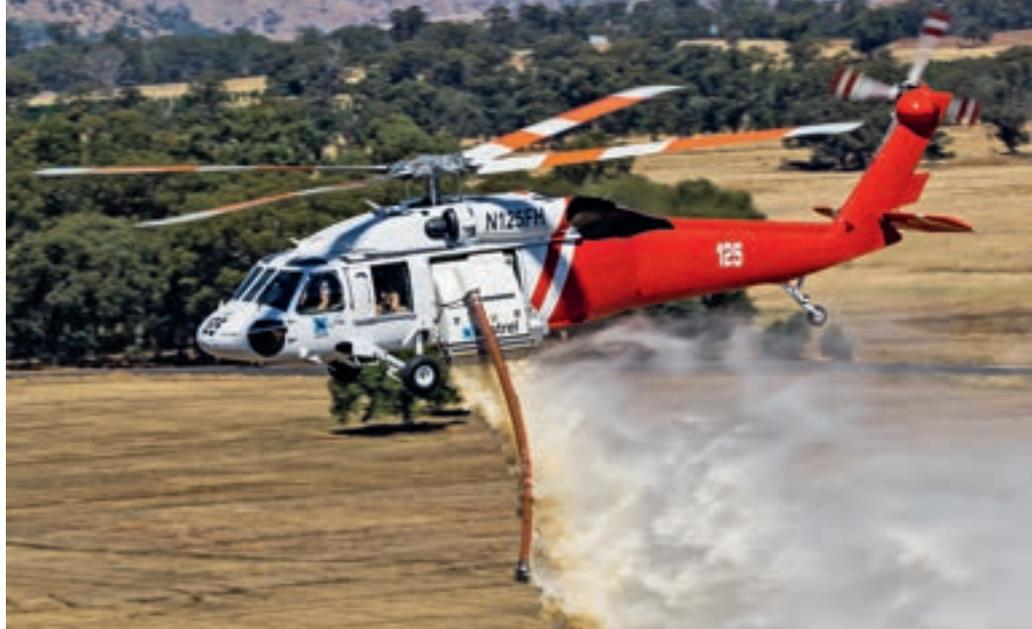
Kestrel Aviation setzt diesen von Firehawks Helicopters gemieteten UH-60A in Australien ein. Gut sichtbar ist der von BHI H60 entwickelte interne Wassertank, welcher 925 US-Gallonen fasst und schnell ein- und ausgebaut ist. Foto Dave Soderstrom
