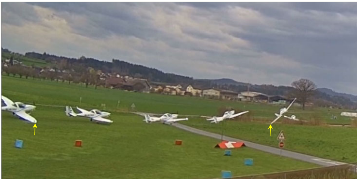
Abbildung 1: Videoaufzeichnung des Startverlaufs mit südlicher Blickrichtung, beginnend von einer Stelle rund 20 m nach dem Pistenende bis zur Unfallstelle (sechs ausgewählte Einzelaufnahmen, kombiniert zu einer Abbildung). Die gelben Pfeile markieren den Bodenkontakt der Tragflächen.
